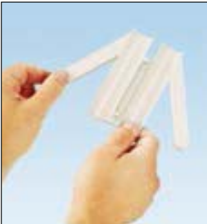
팬랩 작업 공구를 열어 케이블 번들을 삽입한다.
